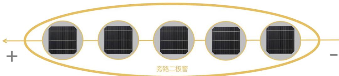
一个旁路二极管保护一个电池片。当组件中某一片电池和组件电流发生失配时，该片电池处于反向偏置状态。但此时只需此片电池承受的反向电压大于旁路二极管的启动电压（0.6V），而不再需要克服传统组件中电池串中其它好电池片的电压就可以使旁路二极管工作。问题电池片承受的反压小，消耗功率少，产生的温度也低。同时也只有问题电池片本身的功率被旁路掉，没有影响其它正常工作的电池片的发电。
