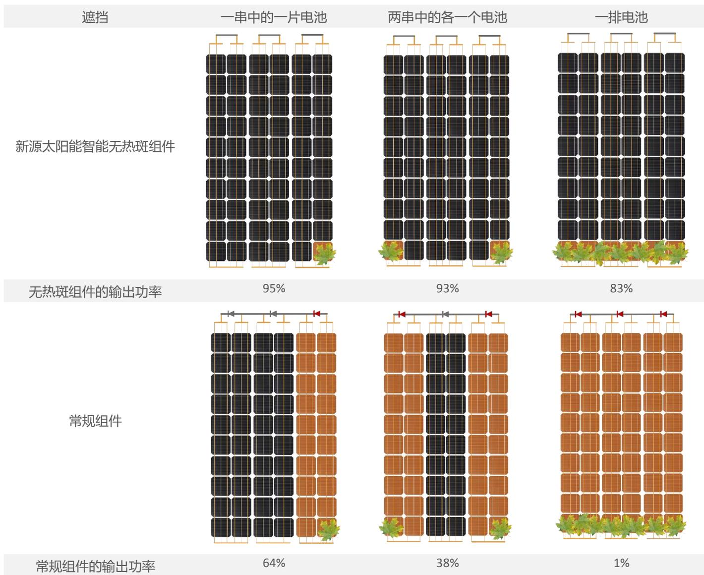
无热斑组件在多电池遮挡情况下比常规组件最多多发电 80% ;
